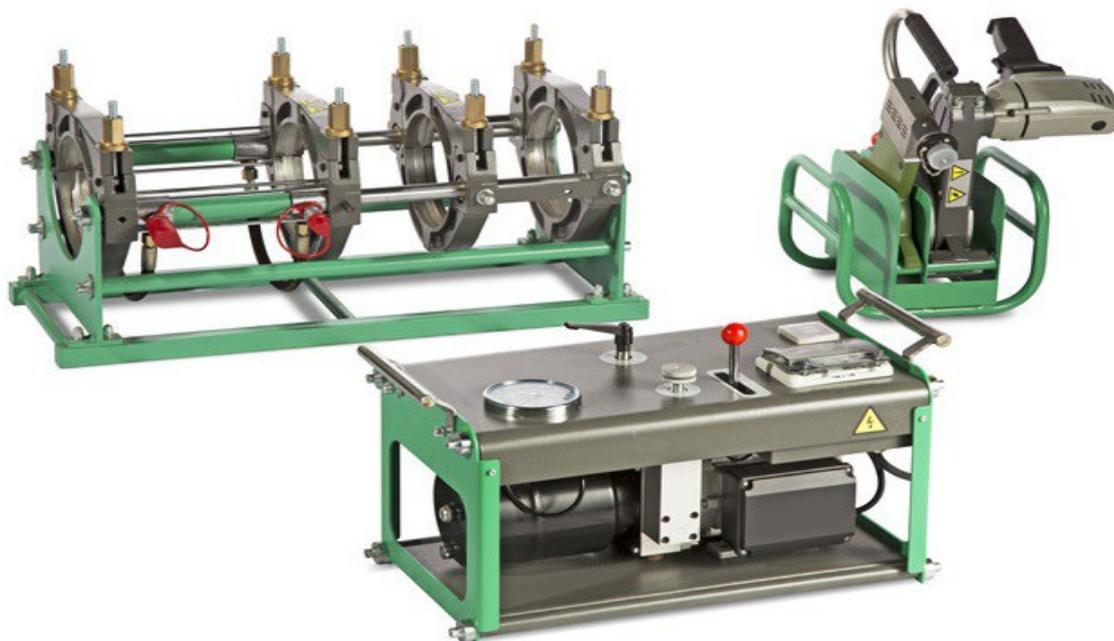
Maquina de Termofusión a tope hidráulica. Se utiliza para soldadura a tope de tuberías y accesorios tales como codos, tes, derivaciones y cuello de brida sin ningún equipo adicional, simplemente ajustando las mordazas de arrastre. Diseñada para la soldadura de tubería y conexiones de HDPE, PP, PVDF.
