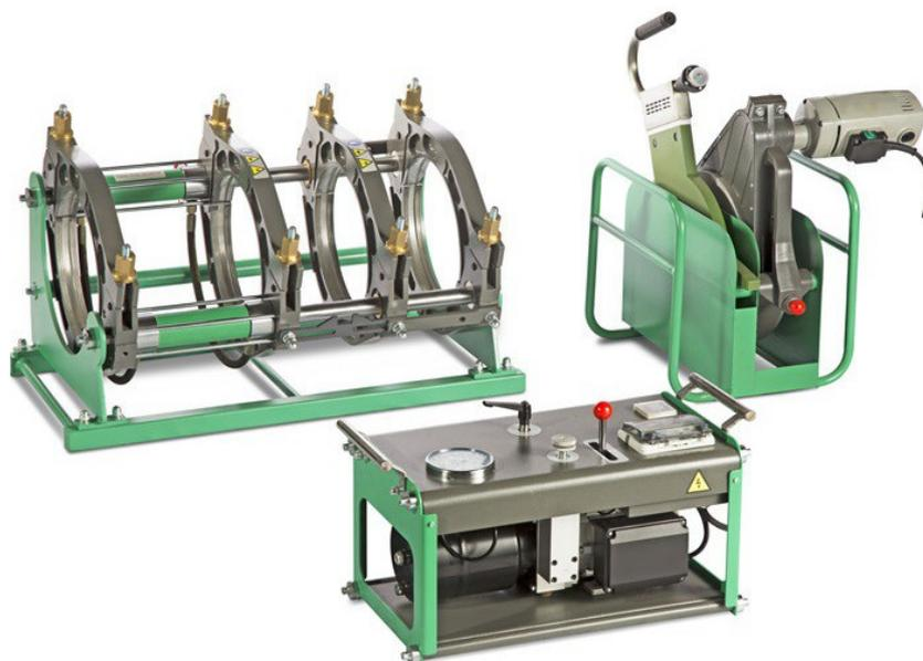
Maquina de Termofusión a tope hidráulica. Se utiliza para soldadura a tope de tuberías y accesorios tales como codos, tes, derivaciones y cuello de brida sin ningún equipo adicional, simplemente ajustando las mordazas de arrastre. Diseñada para la soldadura de tubería y conexiones de HDPE, PP, PVDF.
