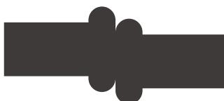
Desalineación. Soldadura bajo la condición de que la desalineación excede el 10% del grosor de la pared de la tubería mientras se alinean los dos extremos.
